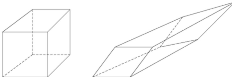
Figura 15 - à esquerda, elemento com baixo skewness . à direita, elemento com alto skewness . Fonte: [11].
