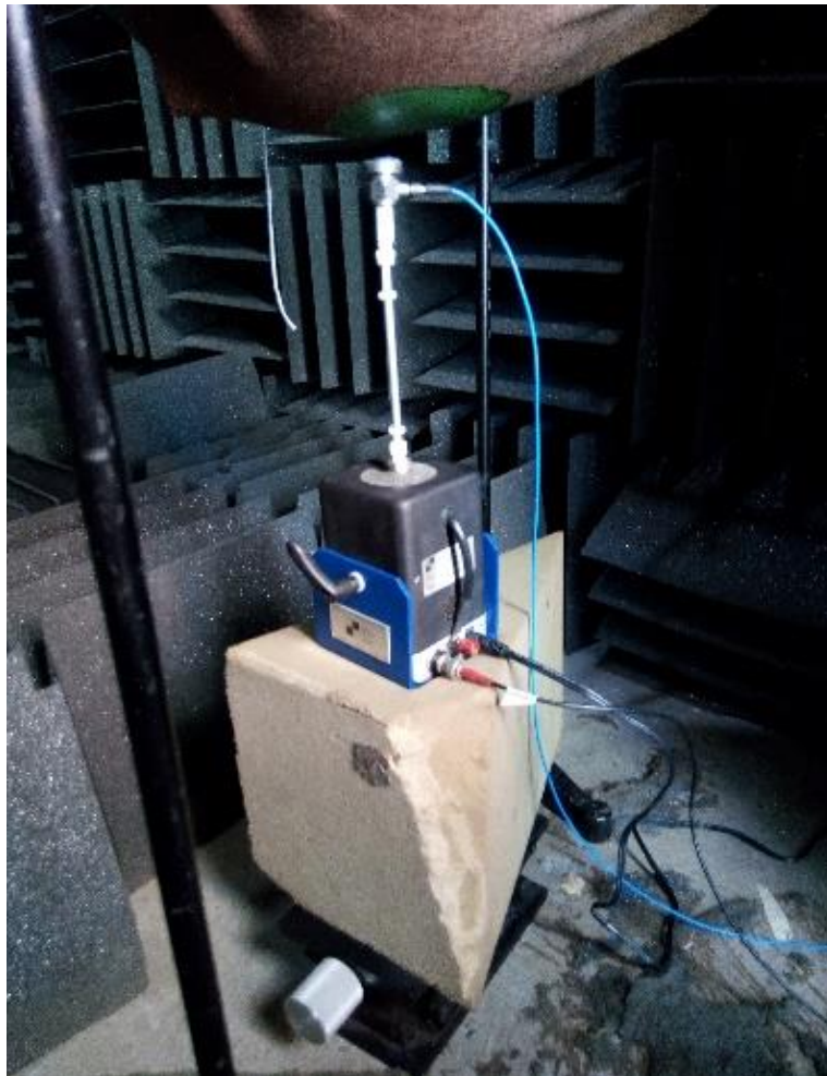
Figura 44 - Posição do Shaker no ensaio. Fonte: Autoral.
