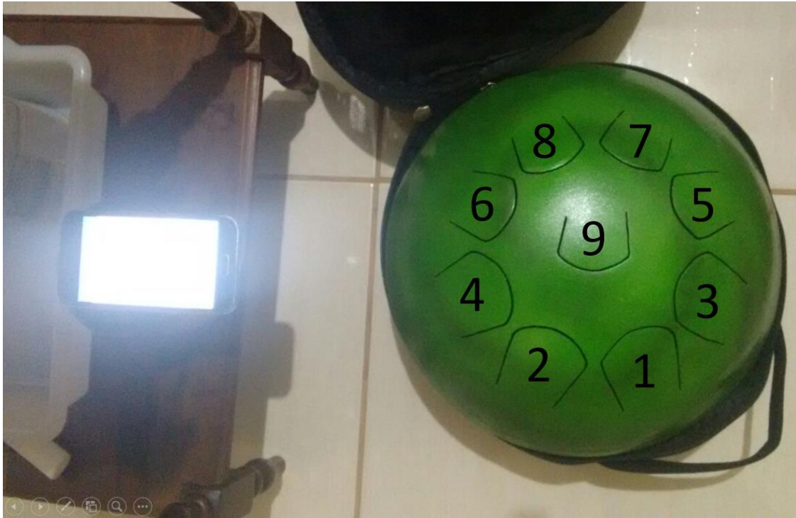
Figura 19 - Posicionamento do celular durante o ensaio acústico. Fonte: Autoral.
